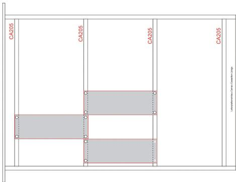
Längseinbau von Leiterplatten mittels Zubehör CA205.
