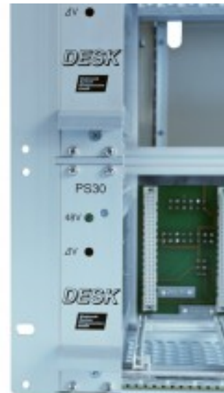
Frontansicht der Netzteile
