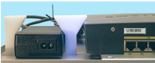
Einbaubeispiel für Geräte der Cisco Series 8xx und dem dazugehörigen Netzteil
