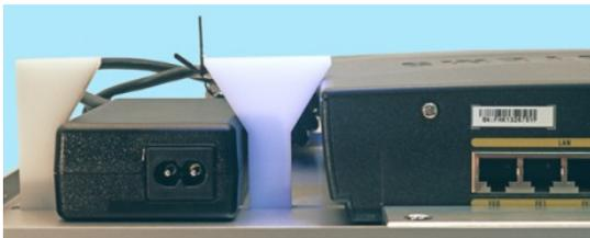
Detail der Klemmung für Netzteil und Gerät. Hier wird ein doppelseitiger Klemmklotz eingesetzt, damit der vorhandene Platz optimal genutzt werden kann.
