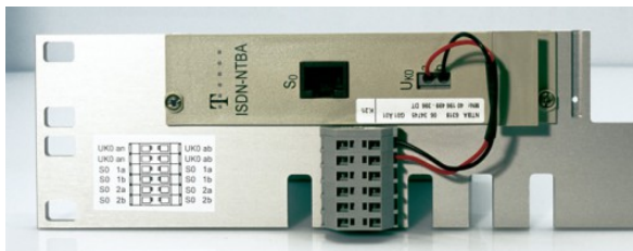
19-Zoll (482.6 mm) Adapter für 3 ISDN-Endgeräteeinschübe
