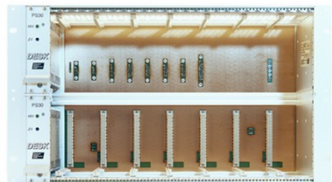
19-Zoll(482.6 mm)-Baugruppenträger für 7 2MBit Endgeräte (NE2SYN)
