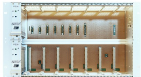
19-Zoll(482.6 mm)-Baugruppenträger für 7 2MBit Endgeräte (NE2SYN)
