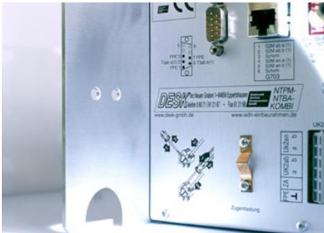
Durchführungen zum Ableiten der Kabel in den Schrank
