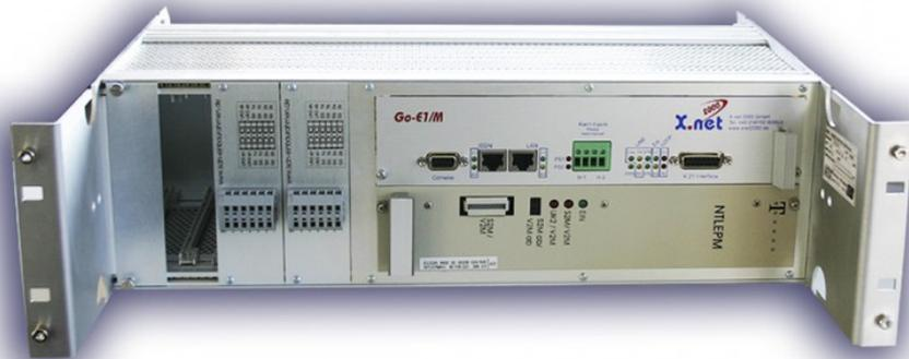
Der Go-E1/M wird in den NTPM-NTBA-KOMBI-Rahmen der DESK GmbH eingebaut. Zusammen mit dem für die Anbindung an die 2MBit/s Standleitung benötigten NTPM (und den evtl. notwendigen ISDN-NTBA's für Fernwartung und Backup-Leitung) entsteht eine homogene und kompakte Einheit, die für alle Geräte nur 3 Höheneinheiten im Verdrahtungsschrank benötigt.
