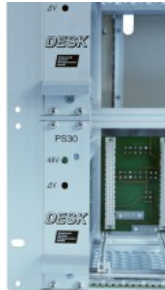
Frontansicht der Netzteile
