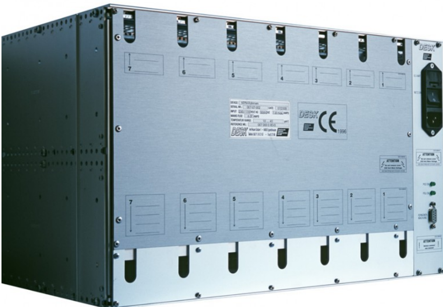
Ansicht der Rückseite mit Netzeingang
