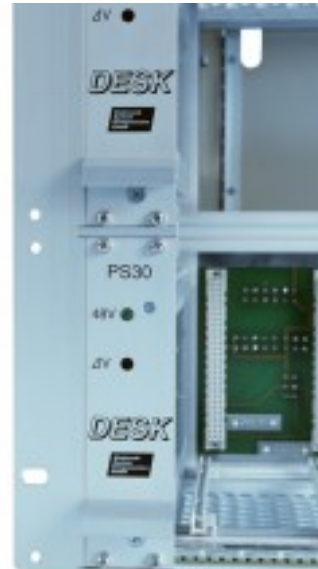
Frontansicht der Netzteile
