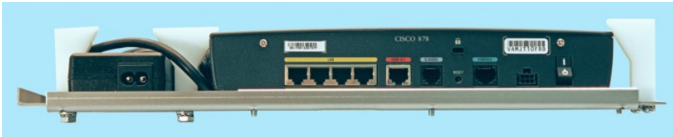
Einbaubeispiel für Geräte der Cisco Series 8xx und dem dazugehörigen Netzteil
