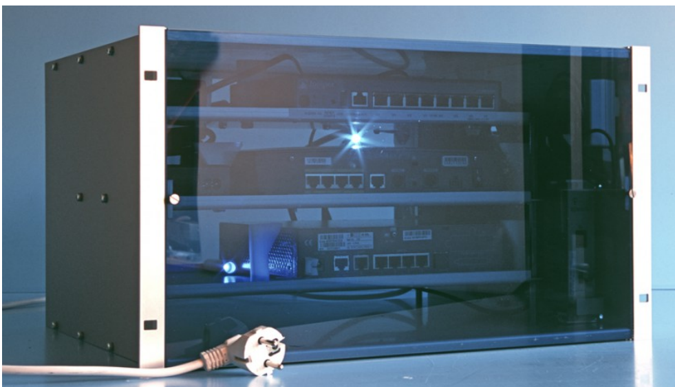
Das komplette Gerät erhält zum Schutz vor unbefugtem Zugriff eine transparente Plexiglasscheibe
